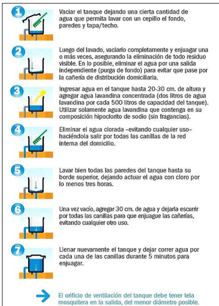
Figura 3. Instrucciones para la desinfección de tanques domiciliarios. (Fuente: Aguas Santafesinas SA).
